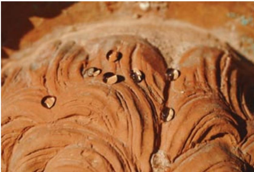
Fig. 8. Verifica del comportamento idrofobico della terracotta dopo il trattamento.
