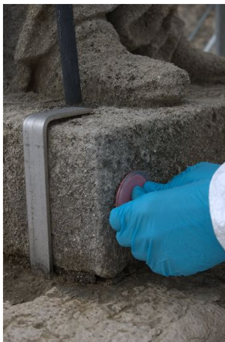
Figura 8: Test di assorbimento d'acqua con il metodo della spugna di contatto delle superfici lapidee trattate con silice nanostrutturata funzionalizzata.
